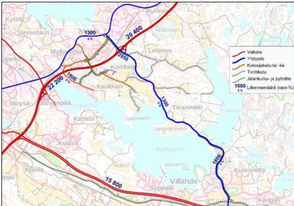
Kuva 8. Suunnittelualan ja lähiympäristön maantiet, kadut ja JKPP-väylät. Liikennemäärien lähteenä käytetty tierekisteriä, Lahden seudun liikennemallia ja poikkileikkauslaskentoja.
