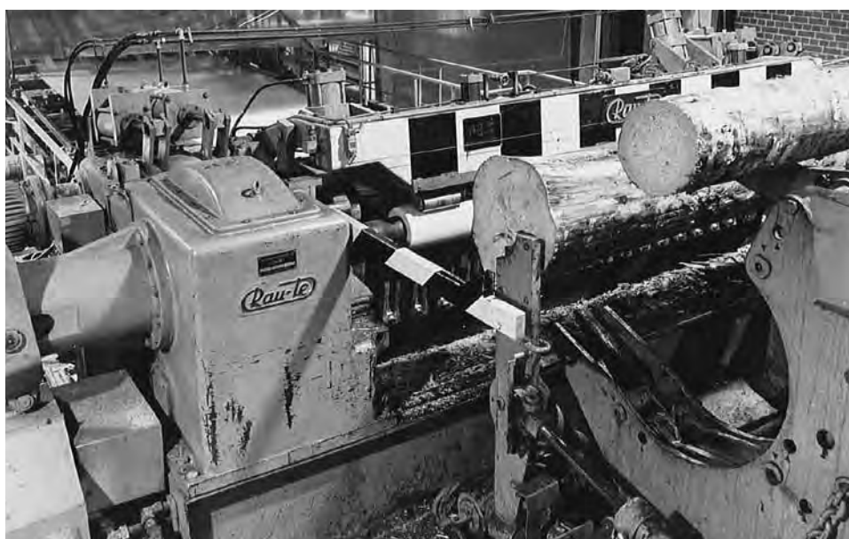
Uusi 100" kuusisorvi, asennettu 1972. (Tehtaan arkisto)
