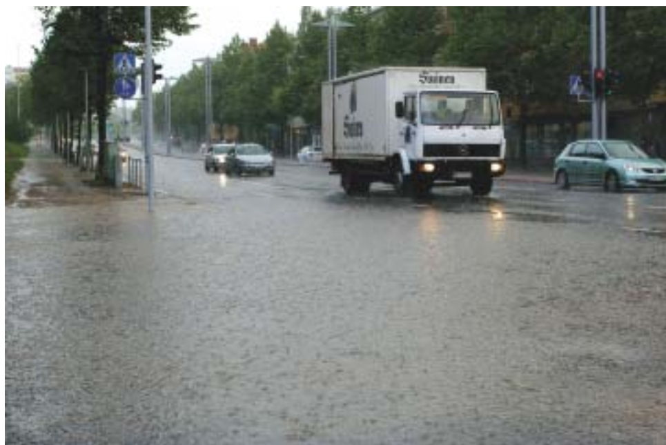
Kuva 4. Kaupungistumisen myötä vettä läpäisemättömien päällysteiden osuus kasvaa. Tiivis kaupunkirakentaminen, riittämättömät viemärikoot ja tulvareitien puuttuminen lisäävät hulevesitulvien riskiä. Kuvassa on Lahdenkatu rankkasateella heinäkuussa 2008.
