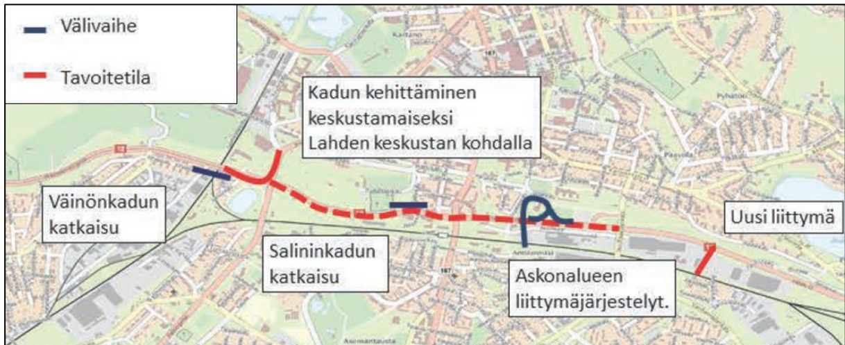
Kuva 6. Valtatien 12 kehittämisselvityksessä (välillä Hollola – Lahti) esitetyt välivaiheen ja tavoitetilanteen toimenpiteet Lahden keskustan kohdalla (Lähde: Vt 12 kehittämisselvitys välillä Hollola – Lahti).
