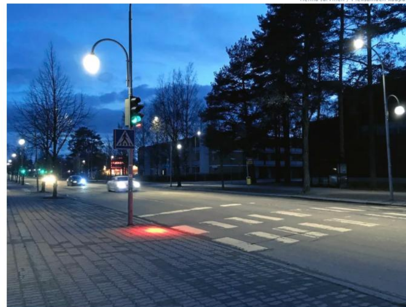
Kadulle heijastuva punainen valo herättää kännykkään uppoutuneen kulkijankin huomion. Pieksämäen Keskuskadulle sijoitettu valo-opaste on tietyvästi ensimmäinen laatuaan Suomessa.
