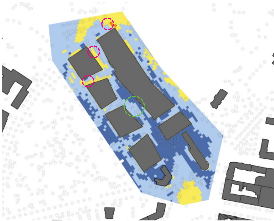
Paikat, joissa syntyy alaspäin suuntautuneita virtauksia (punaiset ympyrät) ja pyörteisiä pystysuuntaisia virtauksia (vihreä ympyrä). Taustakuva: Tuuliviihtyvyyks – tapaus 2 (mukana puut ja pergolat)
