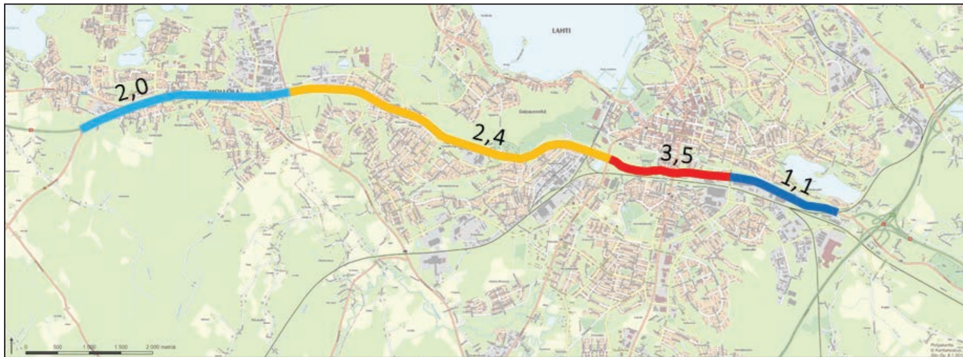
Kuva 2.2. Liittymätiheys (liittymää/km) nykyisellä valtatie 12:lla.
